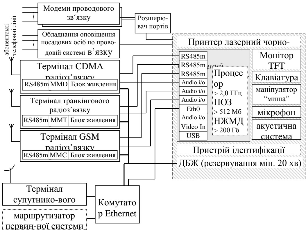
Рис. 1.1 – Структурна схема ПУЗО об'єктової системи оповіщення
