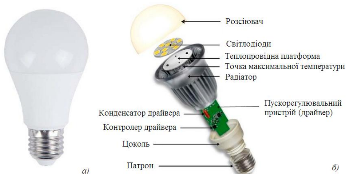
Рисунок 1.8 – Зовнішній вигляд – а та будова – б світлодіодної лампи, призначеної для заміни ламп розжарювання
