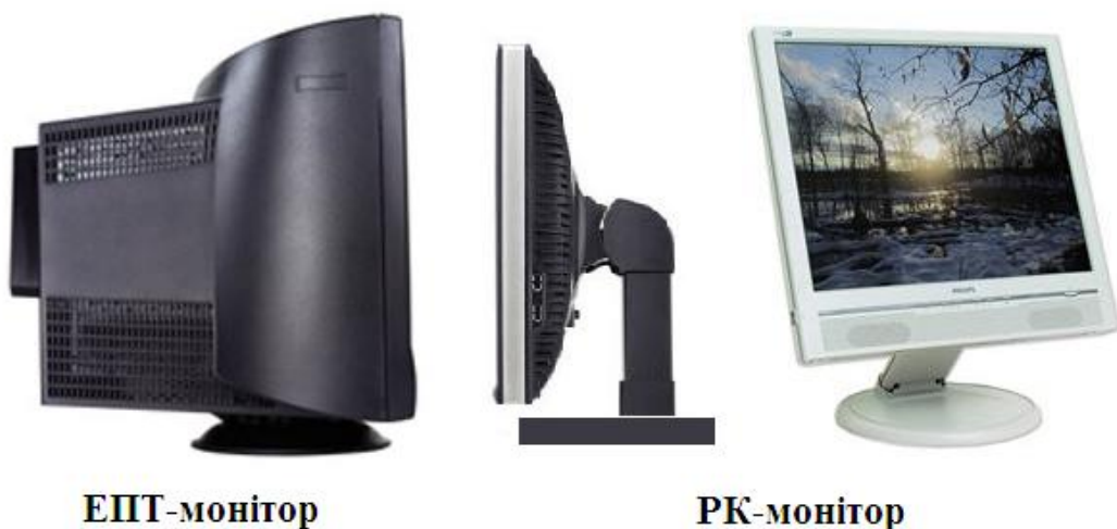
Рисунок 1.6 – Порівняння габаритів ЕПТ та РК-монітора з однаковим розміром екрану
