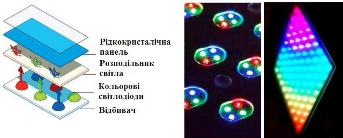
Рисунок 1.9 – Динамічне підсвічування кольоровими світлодіодами
