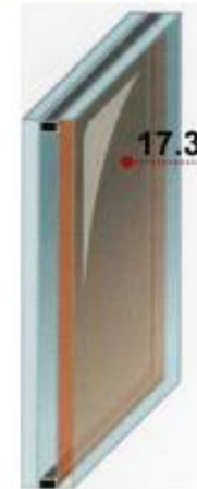
Однокамерний склопакет 4-16Ar-4 TOP N+ R_o=0.70
