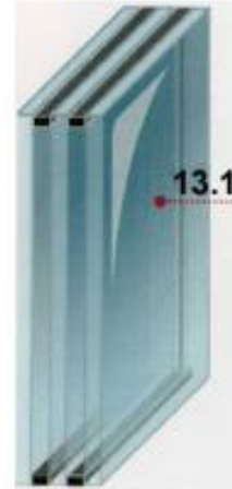
Двокамерний склопакет 4-10-4-10-4 мм R_o=0.49
