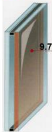
Однокамерний склопакет 4-16-4 мм R_o=0.39
