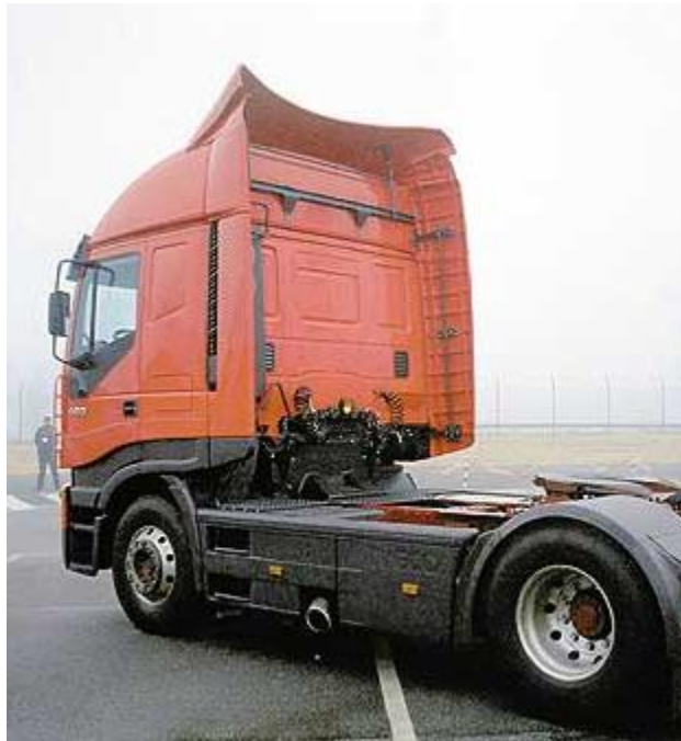
Аеродинамічний щиток (драгфойлер) на даху вантажного автомобіля
