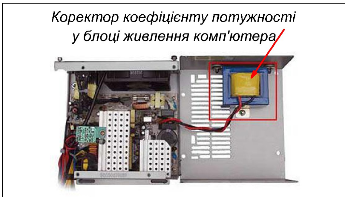
Рисунок 34 – Коректор коефіцієнту потужності у блоці живлення персонального комп'ютера
