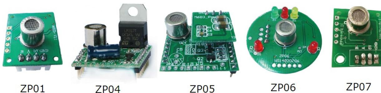
Рисунок 9 – Модули для контроля качества воздуха
